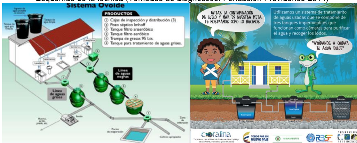
Figura 15 a. Tratamiento de Residuos Líquidos en Johnny Cay Regional Park Esquemas de la técnica (Tomados de diagnóstico: Fundación Providence 2014)
