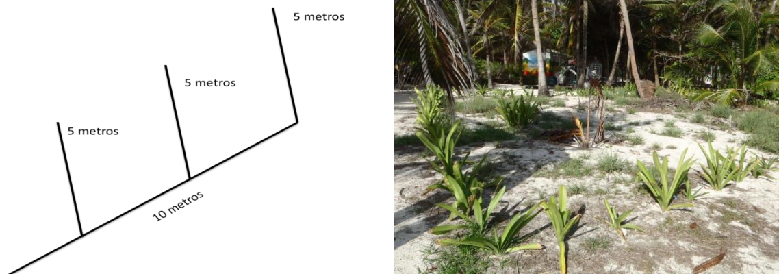
Figura 18. Campo de infiltración del sistema de aguas residuales de Johnny Cay Regional Park (Tomado de diagnóstico de Fundación Providence 2014).
